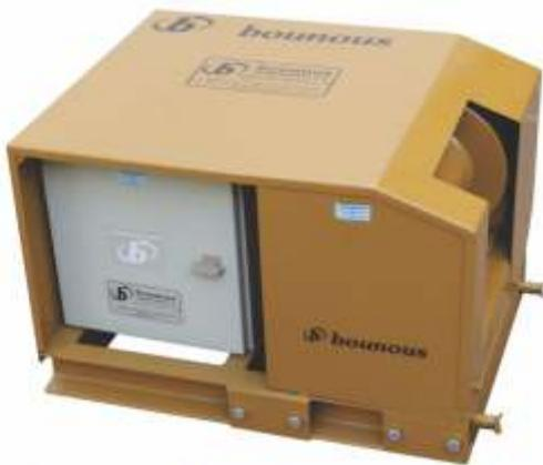
Equipado con motor eléctrico trifásico Spezia con electrofreno, de 5,5 HP a 1500 rpm. Movimiento por medio de reductor de velocidad. botonera cableada al tablero para operación a distancia, con pulsador de subida sin retención y pulsador de bajada sin retención. Con llave termomagnética. Opcional con fines de carrera para detener la plataforma en las alturas deseadas.
