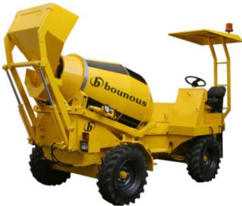
Accionado por motor diesel MWMD229-4 de 73 CV a 2500 RPM, aspirado, de 4 cilindros en línea, refrigerado por agua. Consta de dos chasis articulados por medio de un robusto sistema de rótulas que admiten un giro de 30 grados y una inclinación lateral de  $\pm 7$  grados, lo que garantiza un contacto permanente de las 4 ruedas en el terreno.
