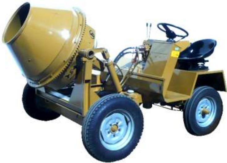
Equipado con motor diesel de 4 tiempos Bounous bicilíndrico de inyección directa, refrigerado por aire, de 24 HP a 2000 RPM.
