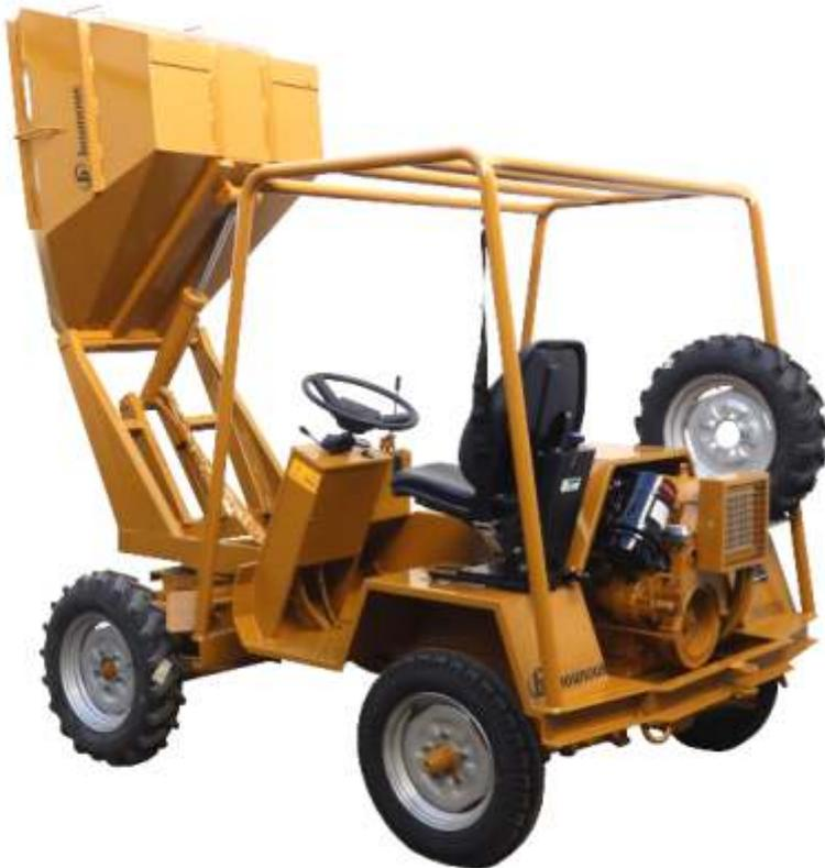
Equipado con motor diesel de 4 tiempos Bounous bicilíndrico de inyección directa, refrigerado por aire, de 24 HP a 2000 RPM.
