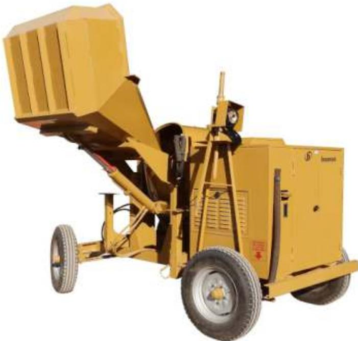
Accionada por motor eléctrico Czerweny trifásico 5,5 HP, 1500 RPM, o motor Bounous 9DB DIESEL de 9 HP.
