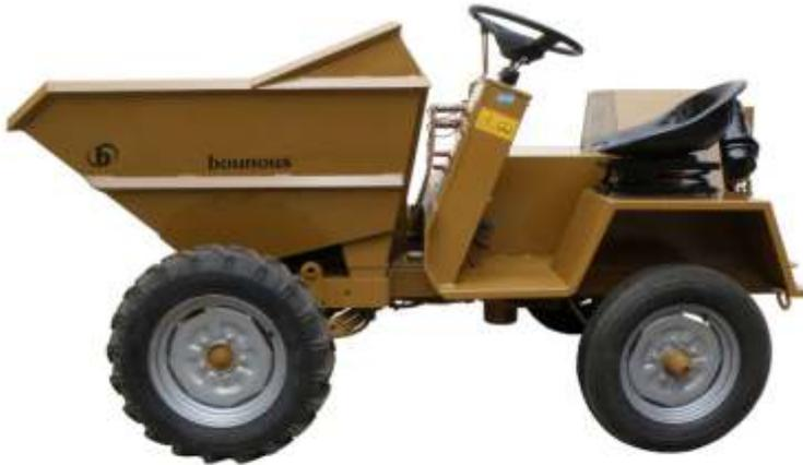
Equipado con motor diesel de 4 tiempos Bounous bicilíndrico de inyección directa, refrigerado por aire, de 24 HP a 2000 RPM.
